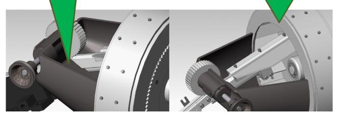
早めにご依頼いただければ、熟練した職人さんの肉盛溶接作業で、ホッパー内面の穴を塞いで接合面のかじりを埋められます。その後ドラムとホッパーの接合面を機械加工で再仕上すれば、新品同様の精度で蘇ります。
